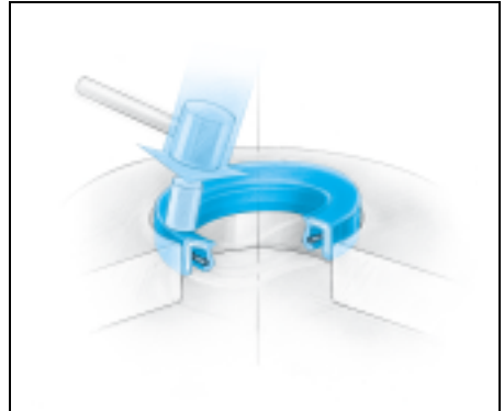
Рис. 2.44 Недопустимый монтаж молотком
