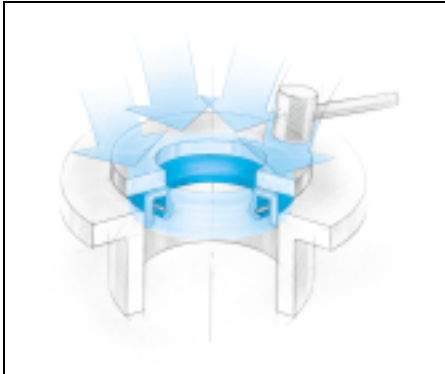
Рис. 2.43 Допустимый монтаж молотком
