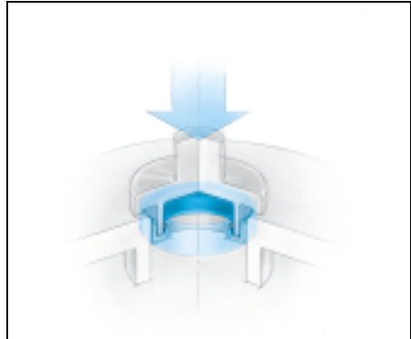
Рис. 2.40 Монтаж основанием вперед
