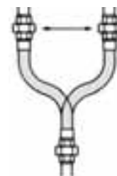
Falsch montiert montage incorrect
