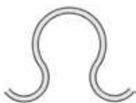
enge Wellung mit «Hinterschnitt» (Omega-Wellung) ondulation serrée de forme «Omega»
