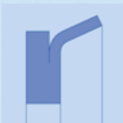
EMTX – Kolbendichtung Topfmanschette mit integrierter Führung.
