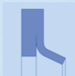
EMHX – Stangendichtung | Abstreifer | Wellendichtung Hutmanschette mit integrierter Führung.
