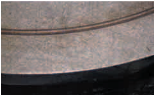
Einlaufrille nach 24 Stunden Run-in groove after 24 hours
