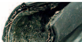
Slange med avleiringer
