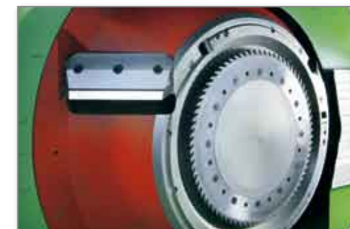
Фрезерный диск, оснащенный длинными ножами и зачистным пильным инструментом
