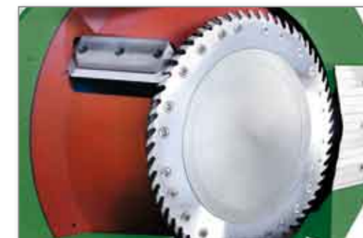
Фрезерный диск, оснащенный длинными ножами и подрезным пильным инструментом
