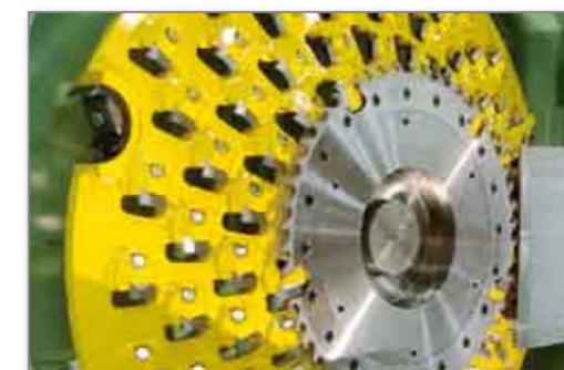
Фрезерный диск со спиральным расположением ножей
